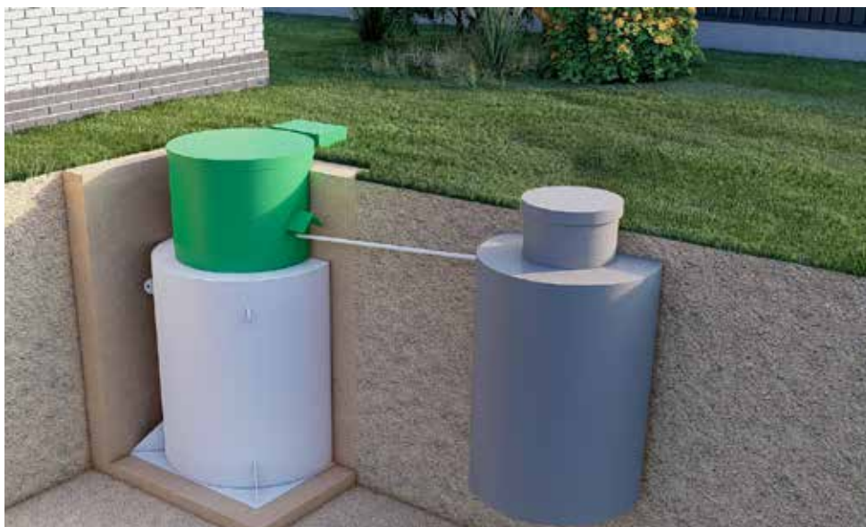
2. Принудительно в фильтрующий или накопительный колодец
